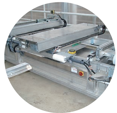
Automatyczny robot transportowy jednowarstwowy wzgl. wielowarstwowy dla ładowania i poboru kontenerów
