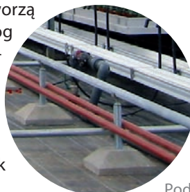
Stacjonarny przenośnik okrężny podwieszony z lub bez pneumatycznych elementów podnoszących
