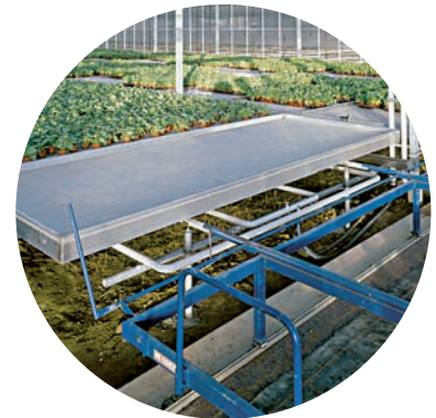
Prowadzony na szynach, ręczny wózek transportowy z systemem ryglującym
