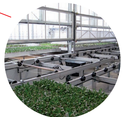
Stacjonarny przenośnik okrężny podwieszony z lub bez pneumatycznych elementów podnoszących
