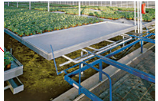
Schienegeführter manueller Transportwagen mit Verriegelungssystem
