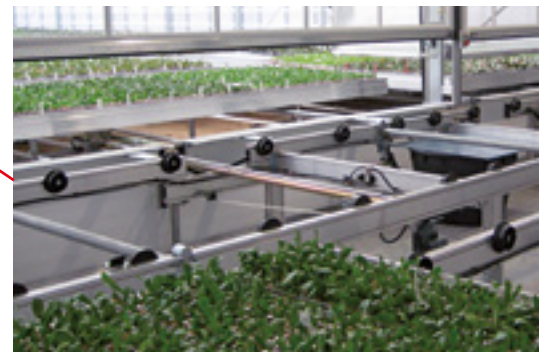
Stationäre Transportbahn mit oder ohne pneumatische Hubelemente
