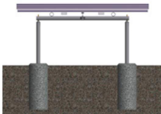
Modell „B“: Verzinkter Stahlerunterbau, mit oder ohne Heizungsauflage, zur Montage in Beton
